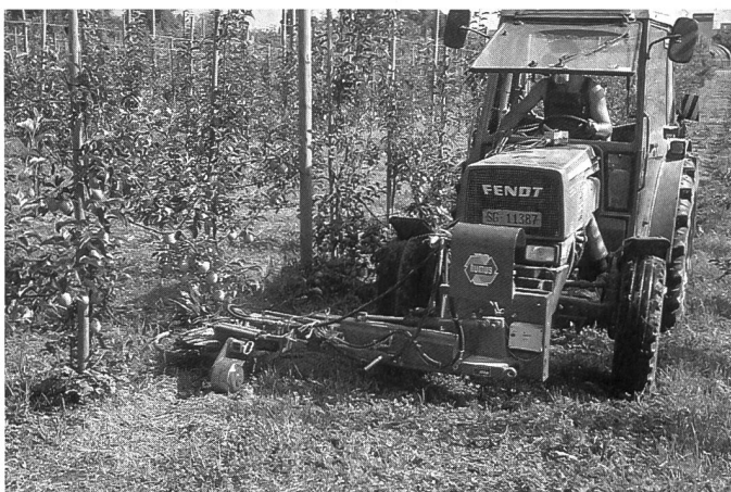
Abb. 1: Mit gezielten Einsätzen der tastarmgesteuerten Hackgeräte lassen sich eine mechanische Bodenpflege und Unkrautregulierung erreichen. Links: Humus, rechts: Ladurner.
