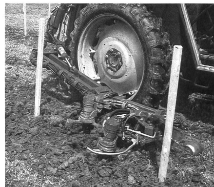
Abb. 2: Mit zwei hydraulisch angetriebenen Messerkreiseln – vorderer Kiesel tastarmgesteuert – konnte der schwere Boden gut aufgelockert und die Grasnarben eingemulcht werden (Ladurner).
