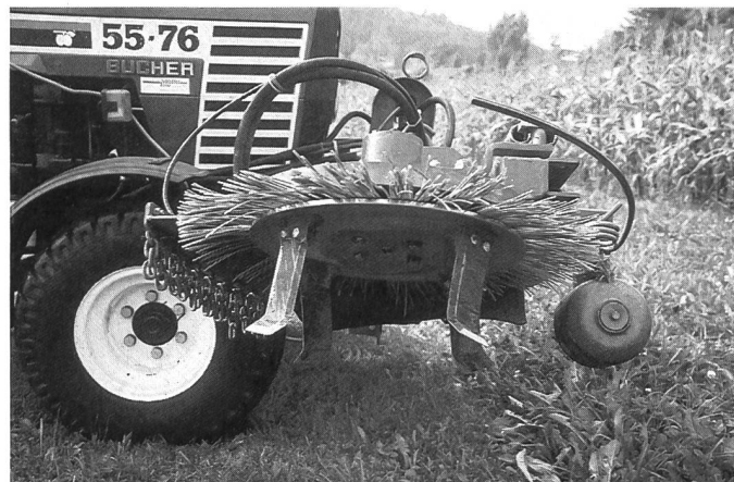
Abb. 3: Ein erfolgreicher Einsatz in schwerem Boden erforderte die 15 cm-Messer (Humus). Rechts: Mit einer umgekehrten Messerstellung wird der Streifenrand gleichmässiger abgeschnitten.
