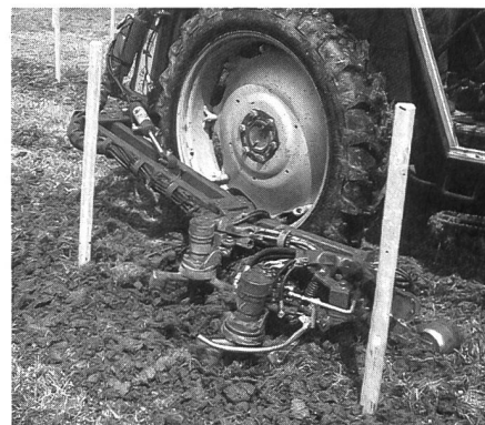
Abb. 2: Mit zwei hydraulisch angetriebenen Messerkreiseln – vorderer Kreisel tastarmgesteuert – konnte der schwere Boden gut aufgelockert und die Grasnarben eingemulcht werden (Ladurner).
