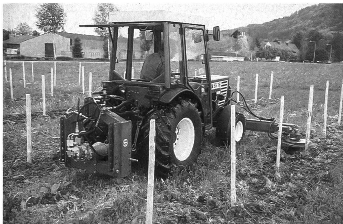
Abb. 3: Ein erfolgreicher Einsatz in schwerem Boden erforderte die 15 cm-Messer (Humus). Rechts: Mit einer umgekehrten Messerstellung wird der Streifenrand gleichmässiger abgeschnitten.
