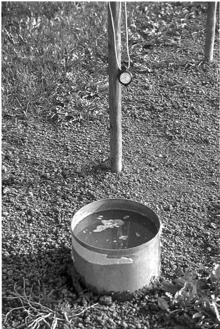
Abb. 6: Die Wasserinfiltration im Baumstreifen wurde mit einem Zylinder – Ø 28 cm, 10 l Wasser und einer Stoppuhr bestimmt.
