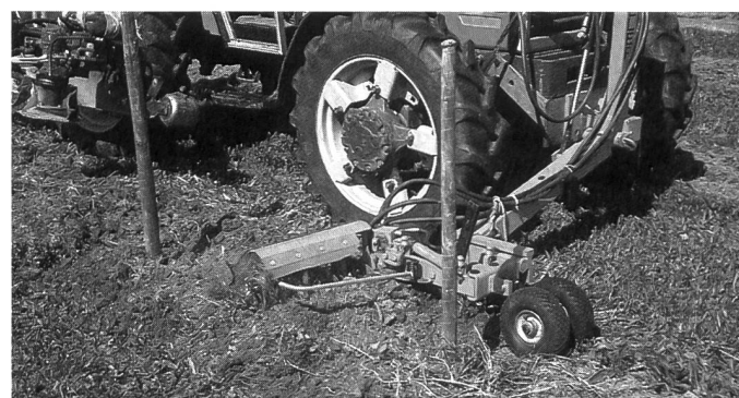
Abb. 4: Der Boden wird mit Flachschar unterschritten und mit dem Messerrotor zerkleinert (Müller). Rechts: Dritter Hackgang 1998.
