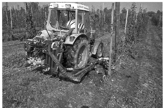
Abb. 1: Mit gezielten Einsätzen der tastarmgesteuerten Hackgeräte lassen sich eine mechanische Bodenpflege und Unkrautregulierung erreichen. Links: Humus, rechts: Ladurner.
