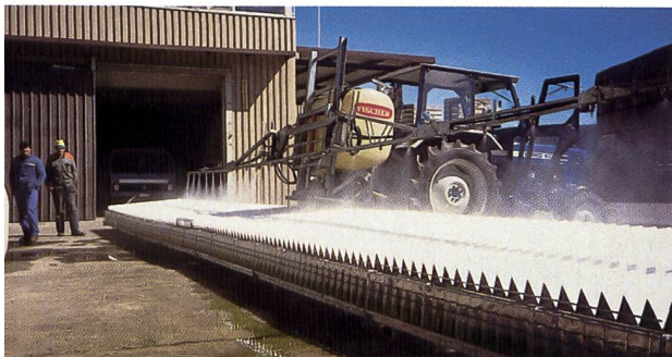
Hauptprüfung: Die gleichmässige Querverteilung des Pflanzenschutzmittels über die ganze Breite des Spritzbalkens.
