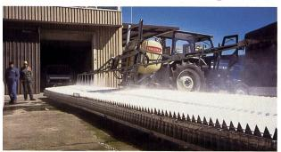
Hauptprüfung: Die gleichmässige Querverteilung des Pflanzenschutzmittels über die ganze Breite des Spritzbalkens.
