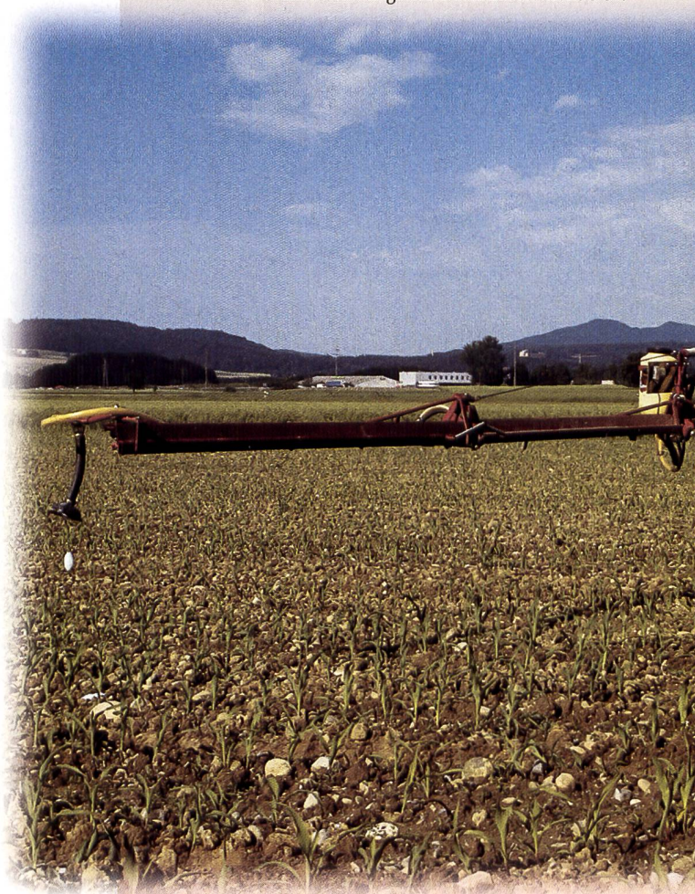
Hauptprüfung: Die gleichmässige Querverteilung des Pflanzenschutzmittels über die ganze Breite des Spritzbalkens.
