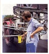
Durchflussmenge pro Düse im Vergleich zum Sollwert: einfache Messgrösse für die Qualtiät der Applikation.
