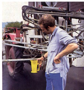
Durchflussmenge pro Düse im Vergleich zum Sollwert: einfache Messgrösse für die Qualität der Applikation.
