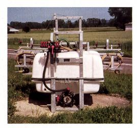
Favaro: Typ SWISS mit Arbeitsbreiten von 10, 12 und 12,5 Meter, einteilbar in 5 Sektoren. Das Gerät weist eine leichte und dauerhafte Konstruktion auf und ist in der Handhabung sehr einfach. Bei den Gelenken des Spritzbalkens wurde auf eine wirksame Federung des Klappmechanismus und auf eine stabile Verbindung der einzelnen Teile geachtet. Die Düsen sind durch Bügel gegen Beschädigungen gesichert.
