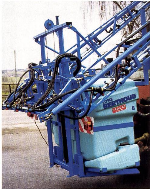
möglich. Die Teilbreiten können manuell oder elektrisch geschaltet werden. Das Gestänge kann mechanisch und hydraulisch ein- und ausgeklappt werden. Der Balken kann mit Vierfach-Düsenträgern ausgerüstet werden und es sind Luft-Injektordüsen und Düsen für die Flüssigdüngung erhältlich.
