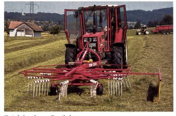
Kreiselschwader am Fronthubwerk: Das Futter wird nicht überfahren, zudem ist die Sicht auf das Gerät für den Fahrer hervorragend. Für den Strassentransport muss der Schwader an die Heckbydraulik umgehängt werden.
