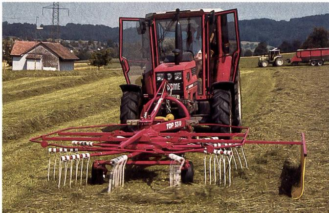
*Kreiselschwader am Fronthubwerk: Das Futter wird nicht überfahren, zudem ist die Sicht auf das Gerät für den Fahrer hervorragend. Für den Strassentransport muss der Schwader an die Heck-hydraulik umgehängt werden.*
