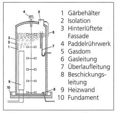
Abb. 3: Beispiel einer Durchflussanlage ohne aufgesetzten Gasometer
