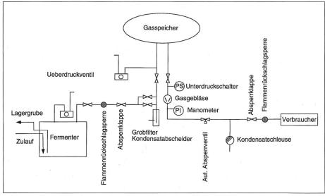
Abb. 2: Beispiel eines Gasschemas mit Sicherheitselementen
