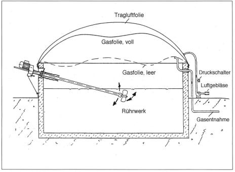
Abb. 4: Beispiel einer Durchflussanlage mit aufgesetztem Foliengasometer
