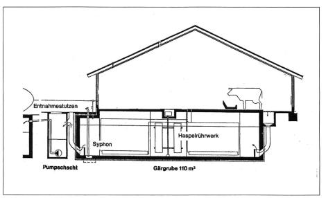
Abb. 5: Beispiel einer unter dem Stall angeordneten Speicheranlage
