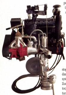
Die Firma hu mai in Häutligen BE bringt eine Hochleistungsschneidepumpe auf den Markt, die für den überbetrieblichen Maschineneinsatz in Lohnunternehmen und Maschinenringen vorgesehen ist. Es werden damit Leistungen bis 200 m³ Gülle pro Stunde erzielt. Die Pumpe ist mit einem 6-Zylinder-Dieselmotor mit 105 kW (144 PS) Leistung ausgerüstet. Diese wird auf eine Horizontalhochdruckschneidepumpe übertragen, die eine Fördermenge bis 200 m³/h bei maximal 15 bar entwickelt und ver-
