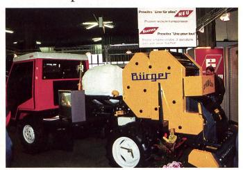
Agromont AG, Hünenberg, zeigte an der AGRAMA eine Kombination von Rundballenpresse (Bürger) und Wickelgerät (Prewitra). Das ganze System ist im Huckepackaufbau konzipiert, aufgebaut auf einem Reform-Transporter. Der Pick-up der Ballenpresse am Heck fördert das Gut in die Presskammer, deren Pressdruck von der Fahrerkabine aus überwacht wird. Nachdem der Pressvorgang abgeschlossen ist, erhält die Balle die Netzbindung und rollt auf den
