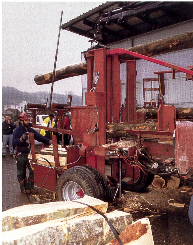
Überzeugende Herstellung von Meterspälten. Die Maschine kostet aber über 90 000 Franken. Sie ist damit wesentlich teurer als die im Handel erhältlichen Profi-Holzspalter zwischen 5000 und 10 000 Franken und auch die Holzhacker zwischen 30 000 und 60 000 Franken. (Bild: Zw.)
