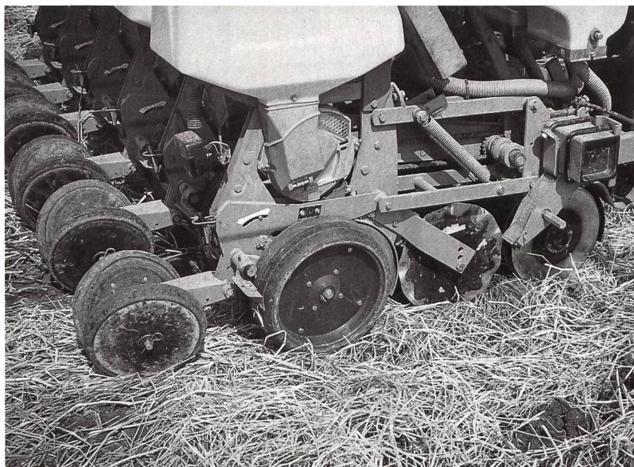
► Für die Direktsaat sollen nur schwere Spezialsägeräte eingesetzt werden, wobei auf einen ausreichend abgetrockneten Boden zu achten ist.
