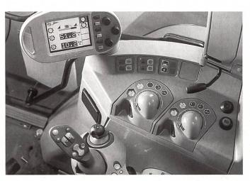
Der Begriff VARIOTRONIC fasst alle neuen Bedien- und Steuerungselemente zusammen. Dazu gehören der neue Vario-Joystick in der rechten Armlehne, der Vario-Terminal und die neugestaltete Bedienkonsole rechts vom Fahrer. (Foto: AGCO/Fendt)
