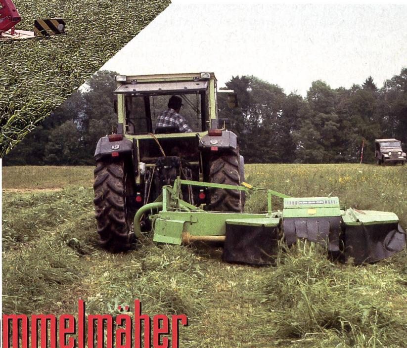
Abb. 2: Trommelmäher im Heckanbau mit integriertem Zinkenaufbereiter mit 1,9 m Mähbreite. Bei Arbeitsbreiten über 2,3 m werden für diese Anbauart aus Gewichtsgründen vorteilhaft Scheibenmäher gewählt.
