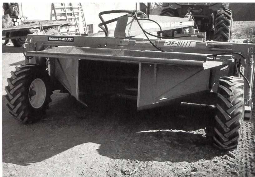
Abb. 3: Gezogene Mähwerke sind in der Regel als Scheibenmäher gebaut. Mit den Schwadformblechen lässt sich die Schwadbreite bis auf eine Breite von 100 cm einstellen.
