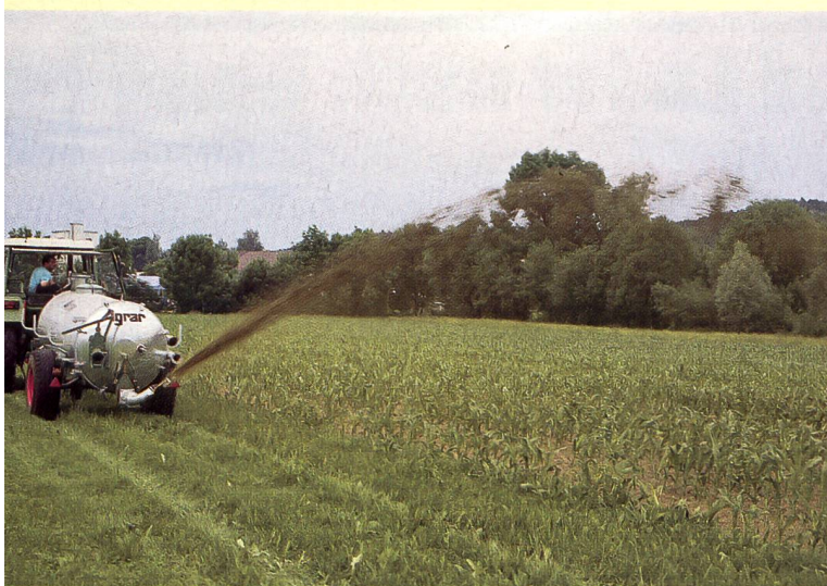
Seitenverteiler kommen allenfalls für das seitliche Bespritzen von Maisäckern oder von nicht befahrbaren Böschungen in Frage. Die Verteilgenauigkeit ist ungenügend.
