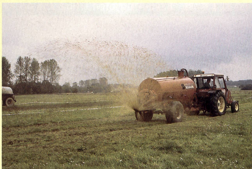
Bei Pralltellern mit grosser Spritzweite wird die Verteilgenauigkeit schon bei leichtem Wind stark beeinträchtigt.
