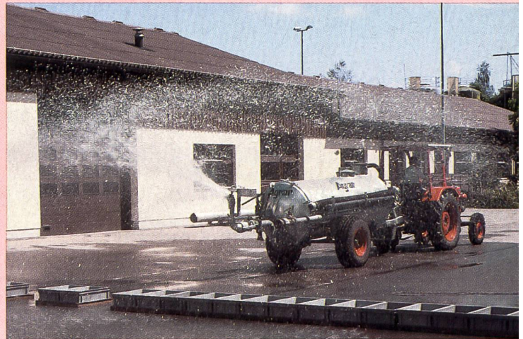
Prüfstand zur Messung der Querverteilung mit Auffangbecken (40 × 60 cm).
