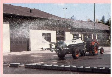
Prüfstand zur Messung der Querverteilung mit Auffangbecken (40 × 60 cm).
