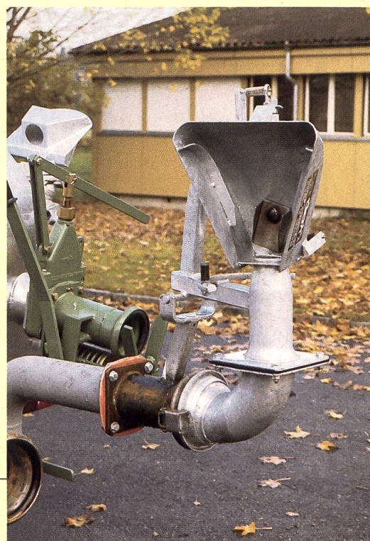
Vertikalverteiler haben gegenüber den Pralltellern den wesentlichen Vorteil, dass die Gülle am Anfang und Ende des Feldes wesentlich genauer verteilt werden kann.
