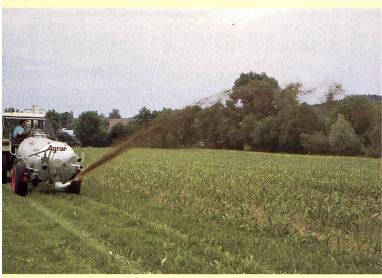
Seitenverteiler kommen allenfalls für das seitliche Bespritzen von Maisäckern oder von nicht befahrbaren Böschungen in Frage. Die Verteilgenauigkeit ist ungenügend.
