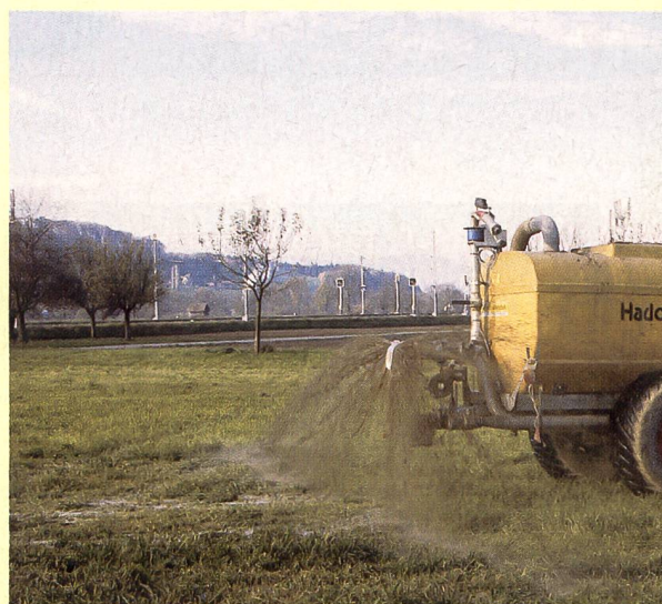
Vertikalverteiler haben gegenüber den Pralltellern den wesentlichen Vorteil, dass die Gülle am Anfang und Ende des Feldes wesentlich genauer verteilt werden kann.
