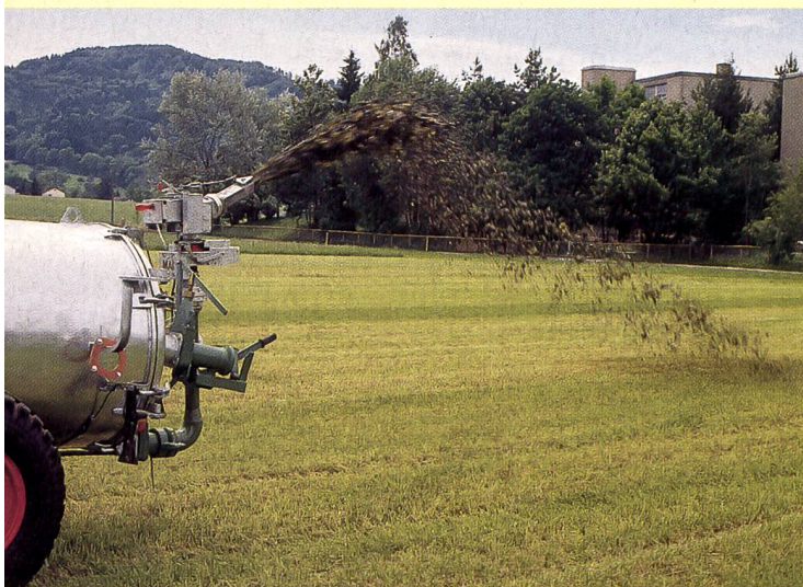
Wegen der fehlenden Sicht auf den Verteiler ist die Bedienung der Schwenkdüse vom Traktorsitz aus nicht ganz einfach. Dies dürfte mit ein Grund sein, weshalb dieses System an Fässern noch wenig verbreitet ist.
