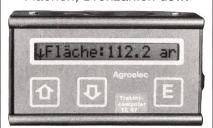
Der TACHOTRON TZ84 für genaue Traktor- bzw. Spritz-Geschwindigkeit
