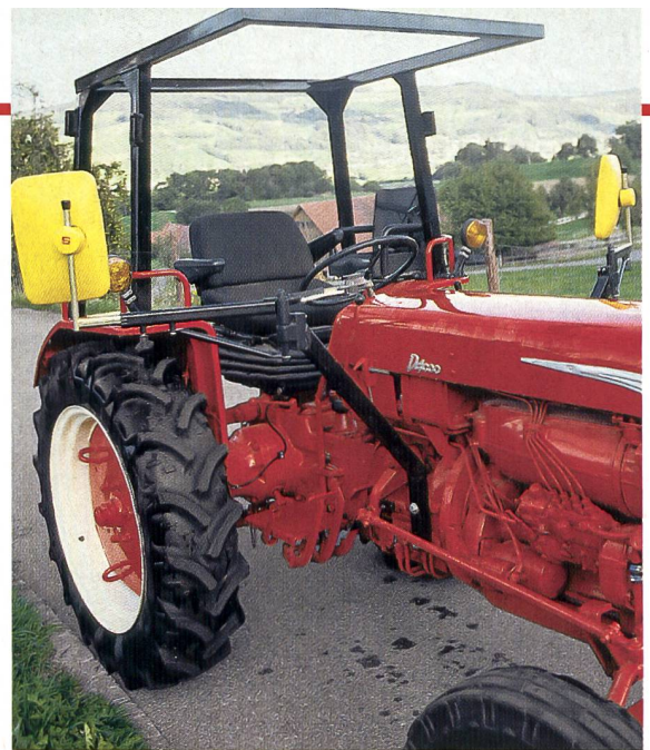
Ein Fahrerschutz kann Leben retten. Mehr als 300 Landwirte wären in den letzten 20 Jahren bei einem Traktorsturz nicht ums Leben gekommen, wenn sie von einer Fahrerschutzvorrichtung geschützt worden wären. (Photos BUL)
