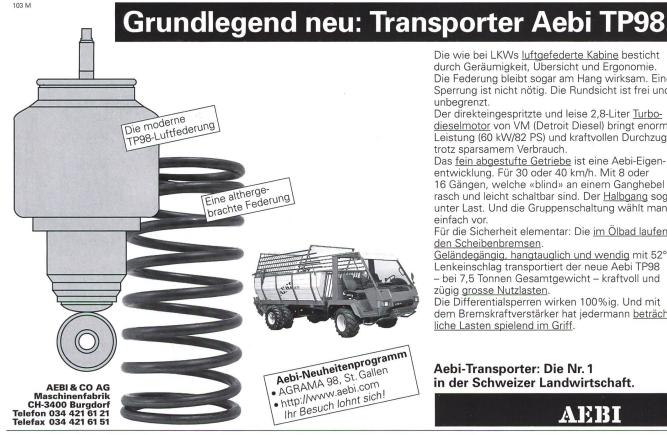
Die wie bei LKWs luftgefederte Kabine besticht durch Geräumigkeit, Übersicht und Ergonomie. Die Federung bleibt sogar am Hang wirksam. Eine Sperrung ist nicht nötig. Die Rundsicht ist frei und unbegrenzt.
