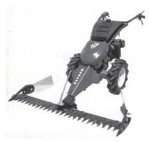
Reform-Bergmäher M7/M8 mit hydrostatischem Fahrantrieb.
