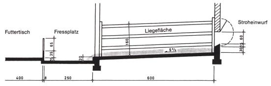
Das Tretmistverfahren ist vor allem für Rindviehmast, aber auch für Kübe geeignet. Die Zeichnung zeigt einen Schnitt durch eine Munimastbucht. Der Fressplatz ist mit einem Palisadenfressgitter ausgerüstet. Das Stroh wird von hinten durch eine Öffnung in der Wand geworfen. (Aus FAT-Bericht Nr. 346)
