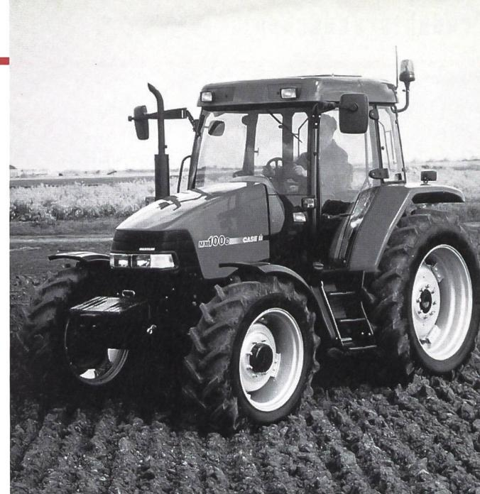
Insgesamt fünf neue Ackerschlepper der Baureihe MX-Maxxum erweitern die landtechnische Angebotspalette von Case IH. Die Typen MX 80 C, MX 90 C und MX 100 C mit Antriebsleistungen von 84, 90 und 102 PS haben ihre Einsatzschwerpunkte im landwirtschaftlichen Mischbetrieb, die Schlepper MX 150 und MX 170 sind mit ihren Motorleistungen von 150 bzw. 166 PS für die schwere Bodenbearbeitung konzipiert.
