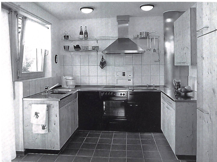
Moderne Küche mit Kombiberd, der sowohl mit Holz als auch elektrisch betrieben werden und mit der Zentralheizung kombiniert werden kann.
