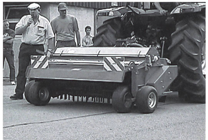
Der Kurmann Twin-Intensivaufbereiter mit der neuen Bürstenwalze.
