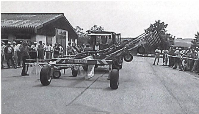
Der Doppelschwader von Krone mit einer Arbeitsbreite von 6,8 m und einem minimalen Kraftbedarf von nur gerade 35 PS bei der Präsentation.
