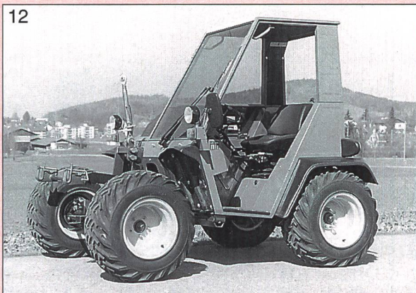
Abb. 6: Traktor VALMET 6200, 4-Zylinder-Turbo mit 59 kW (80 PS), 3-Stufen-Lastschaltgetriebe (Listenpreis Fr. 69 800.-).
