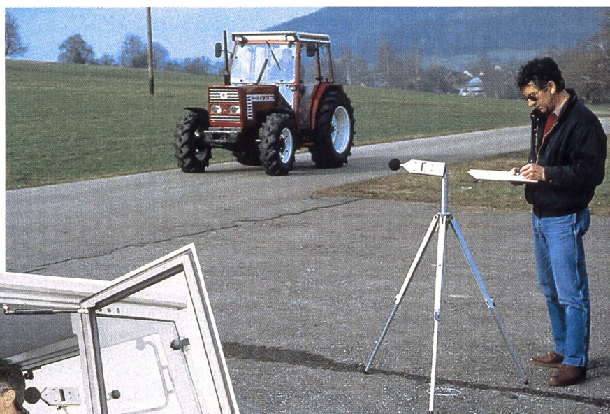
Abb. 5: Lärmmessung bei beschleunigter Vorbeifahrt im grössten Gang in einem Abstand von 7,5 m vom Messgerät. Die Landwirtschaftstraktoren sind oft schon am frühen Morgen oder noch spät abends im Einsatz. Sie sollten auch bei der Durchfahrt durch Wohnquartiere nicht durch übermässigen Lärm auffallen.
