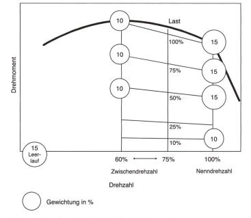
Abb. 2: Messzyklus ISO 8178, C1 (für Dieselmotoren)
