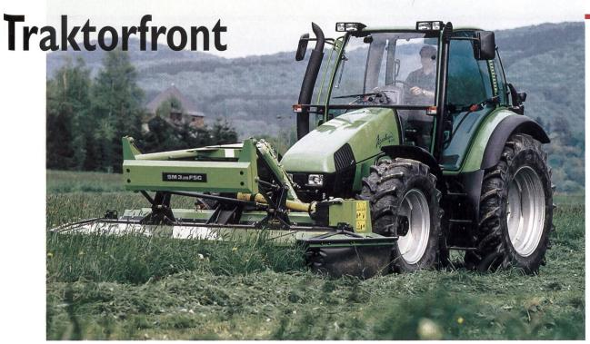
Bild 3: Verbesserung des Nahsichtfeldes durch heruntergezogene Motorhaube. (Werkphoto)
