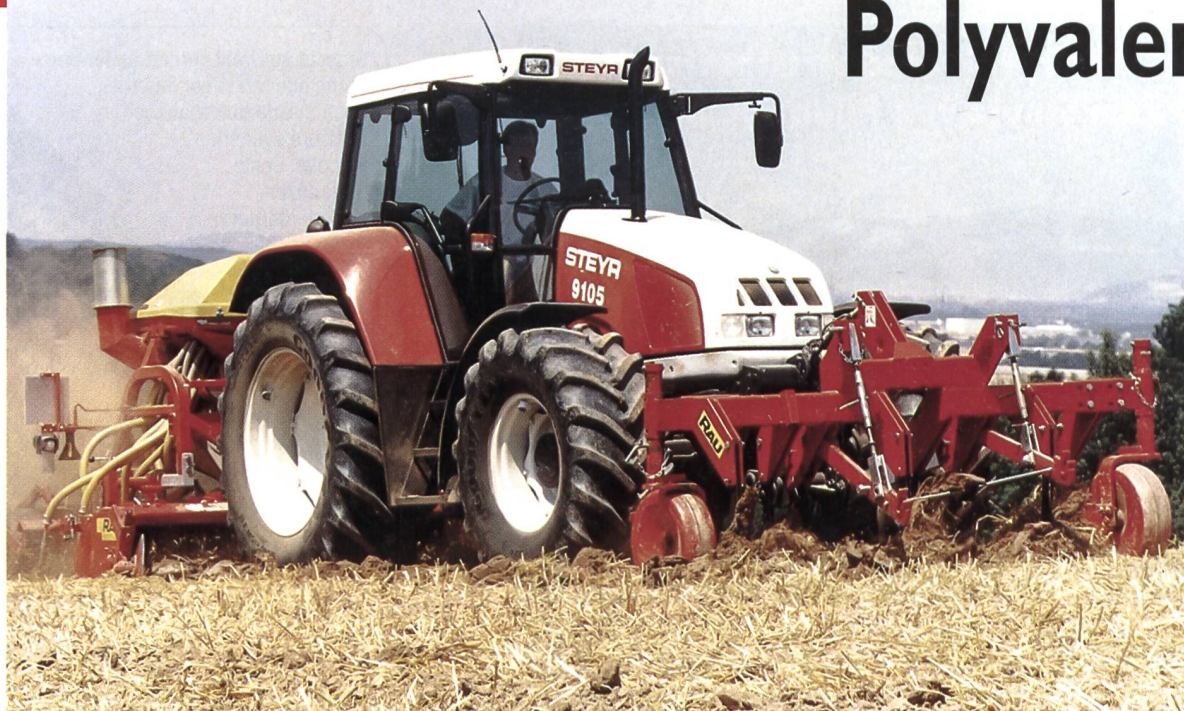
Bild 1: Gerätekombination an Front und Heck zur pfluglosen Bestellung. Der Traktor ist mit dem lastschaltbaren Getriebe T 7000 von ZF ausgerüstet. (Werkphoto)
