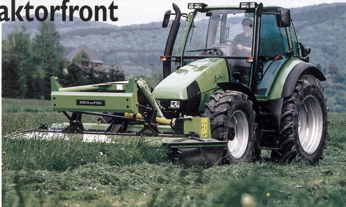
Bild 3: Verbesserung des Nahsichtfeldes durch heruntergezogene Motorhaube. (Werkphoto)
