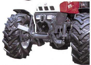
Bild 2: Frontkraftheber an Vorderachse angebracht. (Werkphoto)
