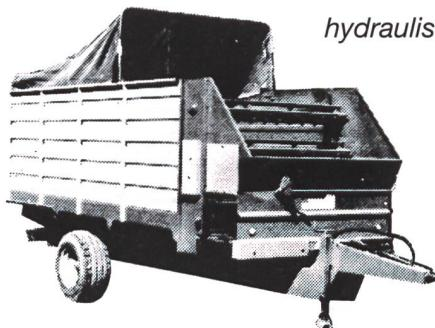
Diverse Modelle: 1- und 2-Achser oder **Tandem**, vor- und rückwärts laufender Kratzboden, beidseits laufendes Gummiförderband, drei Dosierwalzen.
