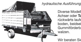
Diverse Modelle: 1- und 2-Achser oder Tandem, vor- und rückwärts laufender Kratzboden, beidseits laufendes Gummiförderband, drei Dosierwalzen.
