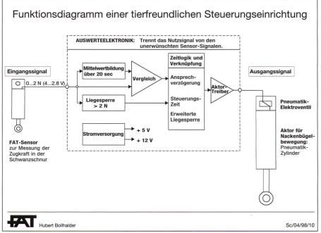
Abb. 2. Die Kombination von Sensorik und Aktorik erfolgt über eine Auswerteelektronik, welche unerwünschte Signale von den Nutzsignalen trennt.
