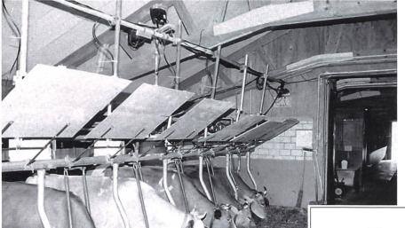
Foto 4. Ein Brett wird pneumatisch in den Kopfbereich der Kuh herabgelassen. Der mechanische Aufwand ist hoch, die Wirksamkeit befriedigend.
