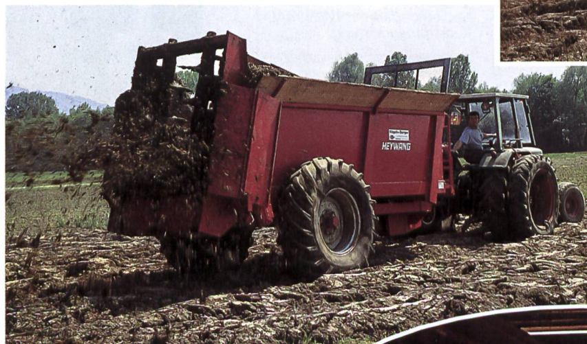
Heckmiststreuer Heywang mit zwei stehenden Walzen. Hohe Stellwände an der zwischen den Rädern gelagerten Wanne bringen das Volumen. Die Traktorbereifung bringt eine grosse Entlastung beim Rollwiderstand im Acker und schont den Boden. (Photos Ueli Zweifel)
