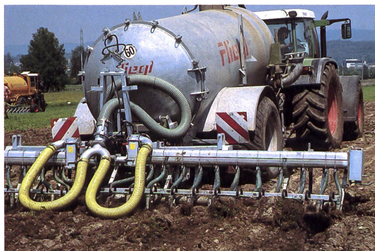
Schleppschuhverteiler mit Grubberzinkenreihe für die sofortige Vermischung von Gülle und Bodenmaterial. Nachteilig kann das Zusammenziehen von Pflanzenmaterial und Erdschollen sein.
