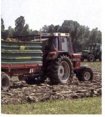
Heckmiststreuer Kirchner mit vier stehenden Walzen. Die Pressung des gepflügten Ackerbodens trotz Tandembereifung ist unverkennbar.
