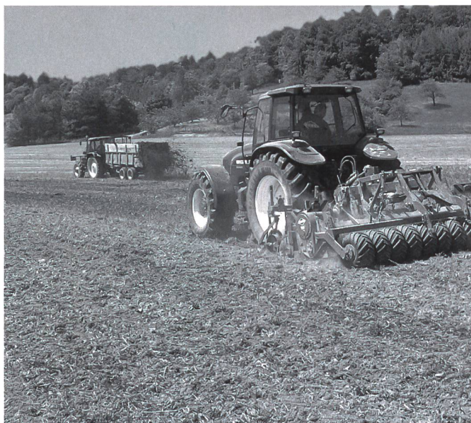
Vielversprechende Kombination für die pfluglose, oberflächliche Einarbeitung von Mist. Zinkenrotor und Bodenlockerung mit Flügelscharen. (Das Bild stammt nicht von der Maschinenvorführung)
