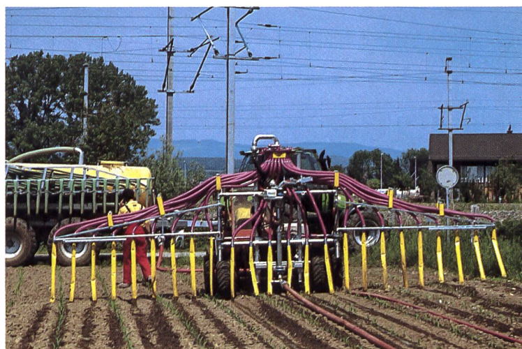
Schleppschlauchverteiler als kostengünstige Variante: mit installierter Weitwurfdüse aufgebaut auf einem Zweiachsenmäher.
