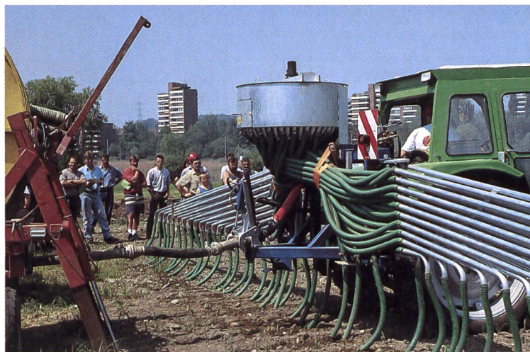
Schleppschlauchverteiler der Oberklasse: Präzision durch zwangsweise Beschickung der Schleppschlauchzuleitungen im Verteilkopf. Das 12 bis 15 Meter breite Aggregat kann in Schichtenlinien parallel zum Gelände geführt werden.
