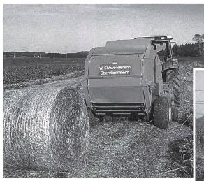
Abb. 3. Rundballenpressen ↑ sind auch für die Bergung von Langpflanzenstroh geeignet. Da Schneidvorrichtungen bisher den Dienst versagten, bedingen Quaderballenpressen infolge der hohen Kolbenbeanspruchung für den Dauereinsatz eine Einkürzung der Pflanzen.→
