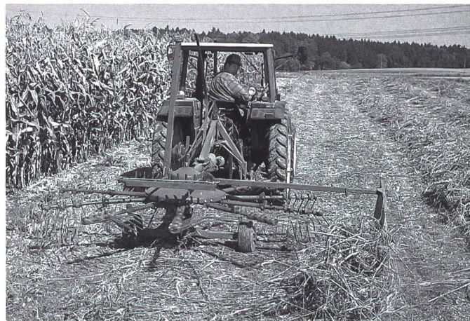
Abb. 2. Kreisschwader liessen sich für das Hanfwenden/-schwaden ohne Probleme einsetzen.
