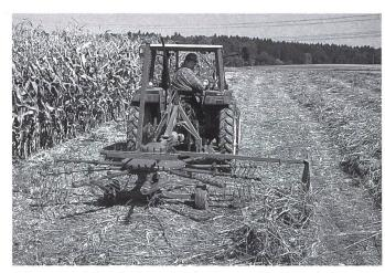
Abb. 2. Kreiselschwader liessen sich für das Hanfwenden/-schwaden ohne Probleme einsetzen.
