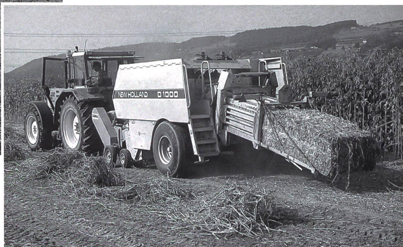
Abb. 3. Rundballenpressen sind auch für die Bergung von Langpflanzestroh geeignet. Da Schneidvorrichtungen bisher den Dienst versagten, bedingen Quaderballenpressen infolge der hohen Kolbenbeanspruchung für den Dauereinsatz eine Einkürzung der Pflanzen. →
