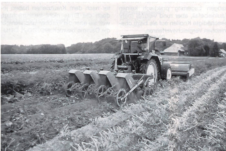
Abb. 2. Ein erfolgreicher Einsatz der Kombination Krautschläger/Krautziehmaschine setzt eine fachgerechte Anbau- und Pflorgetechnik sowie gute Handhabung der Maschinen voraus. Abgetrocknete Böden und Stengel begünstigen den Arbeitseffekt der Luftgummirollen (Gewichte: Traktor 3600 kg, Maschinen 1985 kg).
