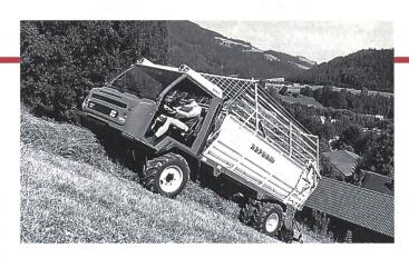
G mit 7 t Gesamtgewicht (12V/8R oder 16V/8R, Scheibenbremsen vorne, Bremskraftverstärker)
