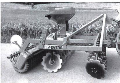
Vario-Disc heißen die neuen Super-Scheibeneggen. Einzigartige Mischwirkung bei flacher (4 – 14 cm) Bodenbearbeitung und hervorragender Einebnung.
