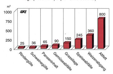
Abb. 2. Biogasertrag verschiedener Abfallstoffe in Kubikmeter pro Tonne Substrat. Der Biogasertrag der meisten Co-Substrate beträgt das 2- bis 4-fache von Güllesubstraten. Speise- und Fettabfälle weisen sogar einen mehr als 20fach höheren Ertrag auf.
