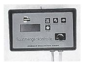
Das Horsch Saatmengenkontrollsystem arbeitet auf der Basis der Infrarotmessung. Die Sensoren werden in die Säschläuche eingesetzt und aneinander in Reihe angesteckt. Die Anzahl der Sensoren kann individuell je nach Bedarf gewählt werden, und es besteht die Möglichkeit, diese nach und nach zu erweitern. Während des Säens zeigt das Display einen Relativwert an, der eine gewisse Saatmenge ausdrückt. Bei einer Änderung der Durchflussmenge, z. B. beim Einschalten der Fahrgasse, Verstopfen
