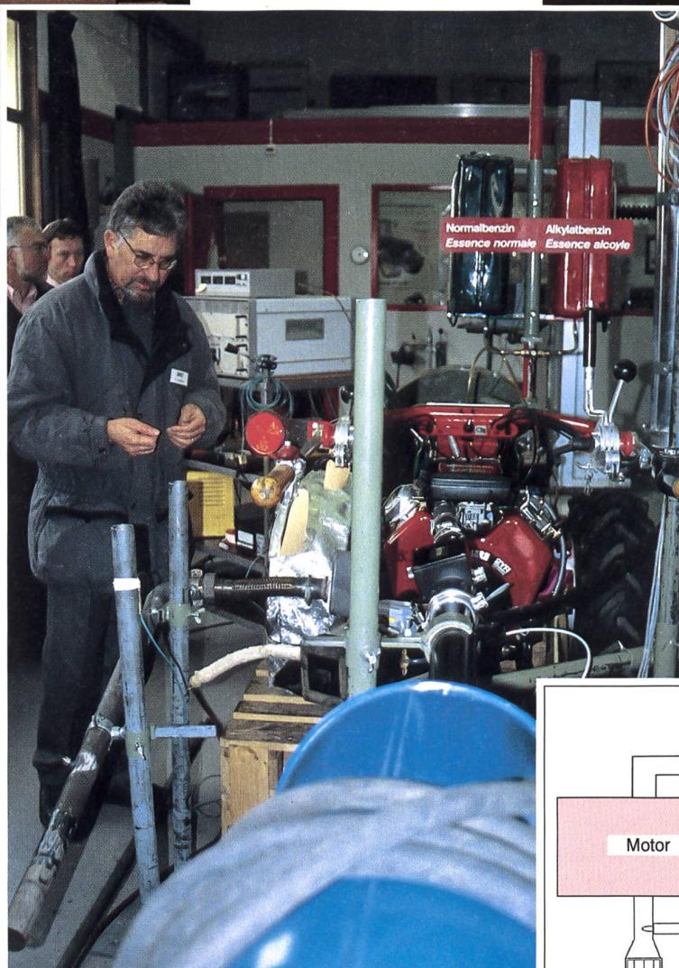
Auf dem Motorprüfstand an der FAT: Die Firma Rapid stellt einen Motormäher der neuen Generation zur Verfügung, auf dem umfangreiche Tests mit Drei-Weg-Katalytor gefahren werden. Der Motorspezialist Edwin Stadler berichtet von sehr ermutigenden Resultaten.
