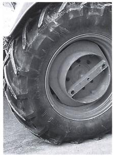
Abb. 9. Hinterreifen standen im Mittel während 3089 Betriebsstunden im Gebrauch. Bei vielen Fahrten auf befestigten Strassen ist die Einsatzdauer kürzer, bei überwiegenden Feldeinsätzen länger.
