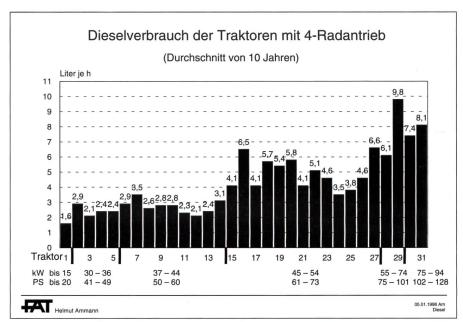
Abb. 14. und 15. Der Dieselverbrauch hängt von der Leistungsklasse, den Einsatzbedingungen und dem Motorenfabrikat ab.
