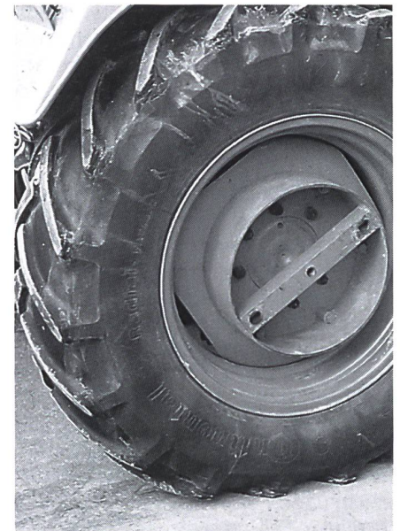
Abb. 9. Hinterreifen standen im Mittel während 3089 Betriebsstunden im Gebrauch. Bei vielen Fahrten auf befestigten Strassen ist die Einsatzdauer kürzer, bei überwiegenden Feldeinsätzen länger.
