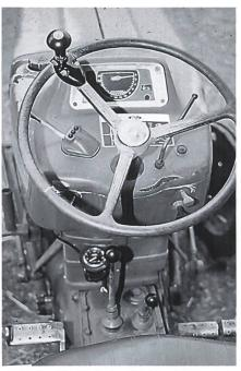
Abb. 2. Ein Teil der Traktoren musste zusätzlich mit elektrischen Stundenzählern ausgerüstet werden, um vergleichbare Stundenangaben zu erhalten.
