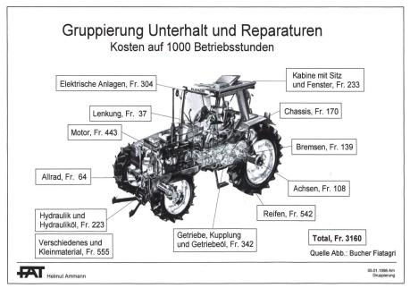
Abb. 8. Zuteilung der Reparaturen auf einzelne Traktorteile.
