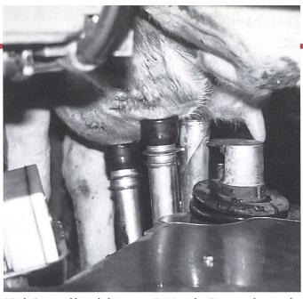
Mittels Laserstrahl wird die genaue Position der Zitze gesucht, um den Becher sicher anzusetzen.
