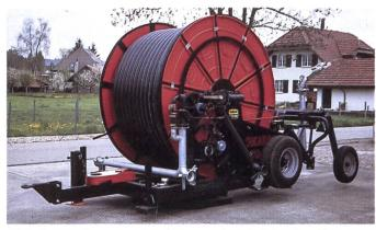
Die grösseren Beregnungsmaschinen werden auch in absenkbarer Ausführung angeboten. Dadurch lässt sich die Maschinenhöhe reduzieren.
