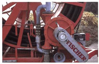
Unter den verschiedenen Antriebssystemen ist die Turbine am meisten verbreitet. Die By-pass-Leitung dient der Steuerung der Einzugstrommel. Der Zapfwellenstummel unter der Turbine ermöglicht den Schnelleinzug über den Traktor.
