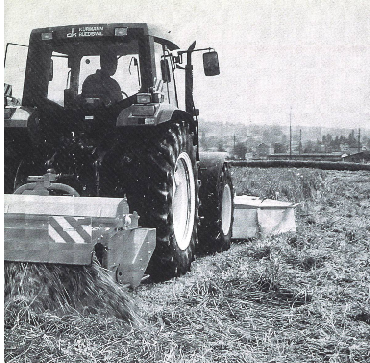
K 618 Twin: Leitbleche der Breitstreuvorrichtung verteilen das aufbereitete Futter auf der gesamten Mähbreite.
