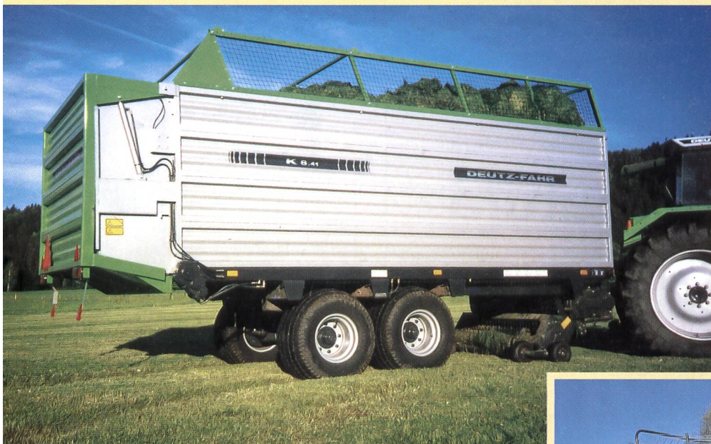
Deutz-Fahr: Mit Stützrädern und mit Arbeitsbreiten bis zu 1,80 Metern versehene Pick-ups für die Profi-Wagen sorgen für höhere Futteraufnahme und bessere Kurvenfahrt beim Ladevorgang (Werksfoto).
