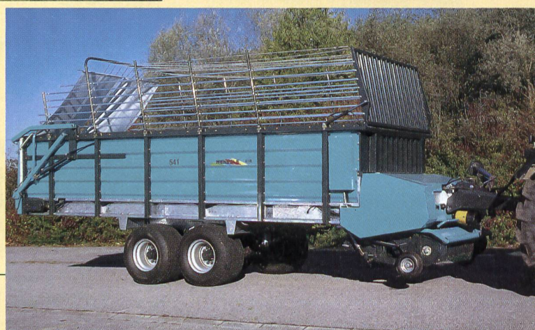
Mengele: Stabiler Aufbau mit geraden durchgehenden Bordwänden für ein sicheres Entladen (Werksbild).
