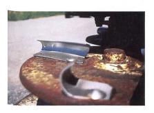
Ohne regelmässige Reinigung und Pflege kann auch der beste Streuer nicht bestehen. Düngerreste sind sofort zu entfernen, abgenutzte Teile (z.B. abgeschliffene, sogar durchlöcherte Streuschaufeln wie hier) zu ersetzen.
