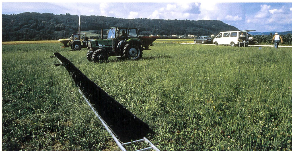
Im Kanton Aargau wurden 1995 und 1996 rund 60 Schleuderstreuer auf Verteilgenauigkeit im Feld geprüft.
