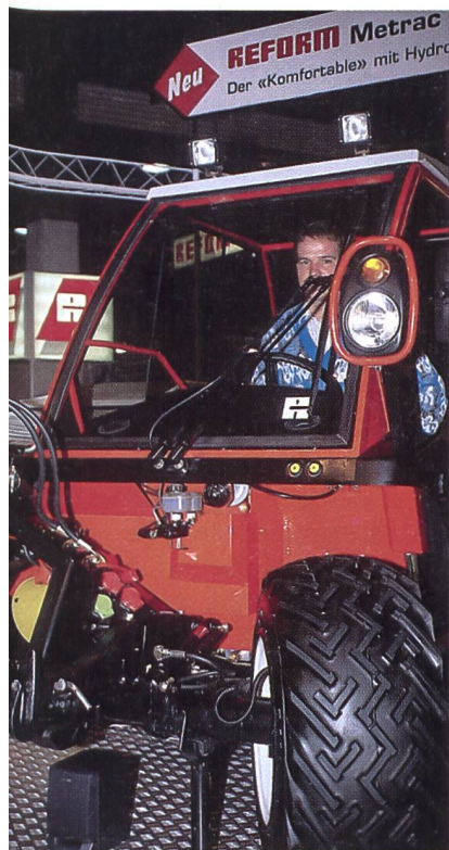
Seitlich verschiebbare Fronthydraulik am Reform Metrac H5.
