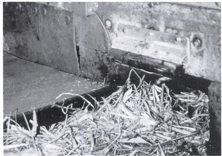
Abb. 8. Können bei Entmistungsanlagen die Sicherheitsabstände nicht eingehalten werden, so sind an Gefahrenstellen Kontaktleisten einzubauen.
