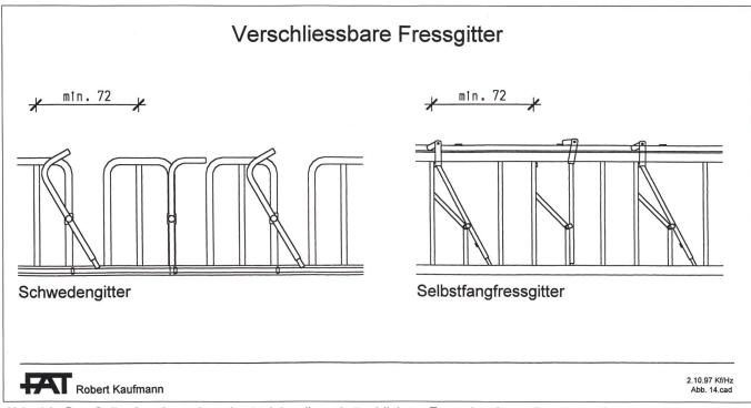
Abb. 14. Das Selbstfangfressgitter (rechts) ist die gebräuchlichste Fressgitterform. Das Selbstfangfressgitter in Palisadenform (links), auch Schwedengitter genannt, ist für behornte Tiere besonders zu empfehlen. Der oben offene Kopfbereich erlaubt ungehindert das Ein- und Ausfahren. Halsbandsicherungen am unteren Ende des beweglichen Gitterelements verhindern, dass sich die Tiere mit dem Transponderhalsband verhaken (Masse in cm).
