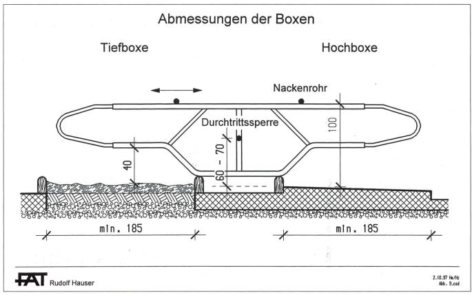
Abb. 9. Bei Tiefboxen bildet eine Strohmatratze eine weiche und verformbare Unterlage. In der Hochboxe ist der Boden mit einer leicht eingestreuten Gummimatte versehen (Masse in cm).
