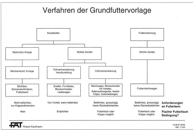
Abb. 17. Die Rauhfuttervorlage wird in Zukunft noch stärker mechanisiert werden. Die Übersicht zeigt die gebräulichsten Techniken mit den entsprechenden Anforderungen an das Futtertenn (nach Pirkelmann 1990).
