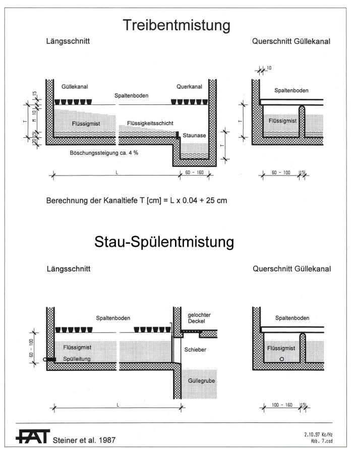
Abb. 7. Wie eine Treibentmistung zu planen ist. Beim Stau-Spülsystem sind Position und Ausführung der Spülleitung und des Schiebers für die Funktion entscheidend (Steiner et al. 1987) (Masse in cm).
