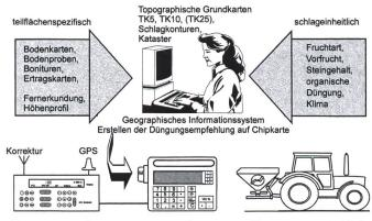
Abb. 5: Datenerfassung, Datenverarbeitung, Applikation am Beispiel der teilflächenspezifischen Düngung.
