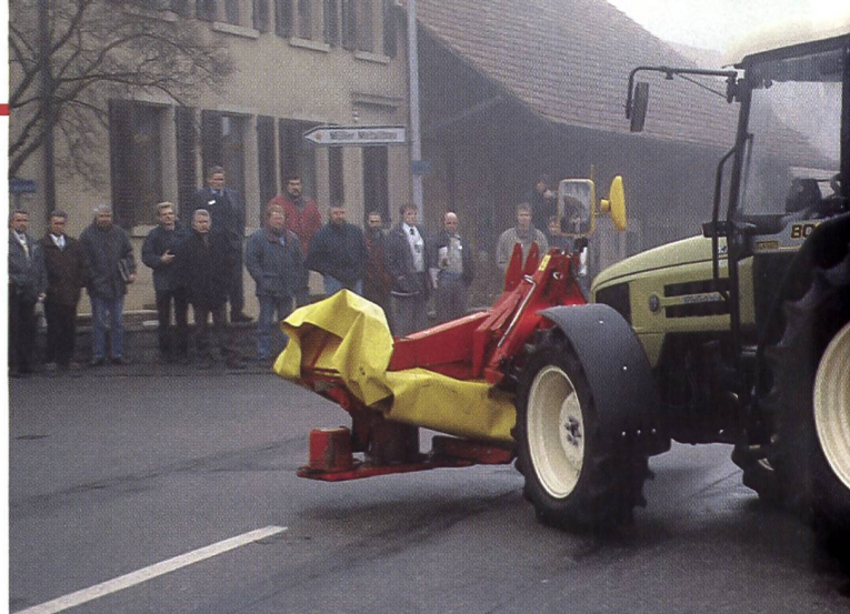
Grosser vorderer Überhang – zwei abgewinkelte Seitenspiegel (BUL-Sortiment) entschärfen die alltägliche, nichtsdestotrotz gefährliche Verkehrssituation.
