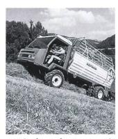
• Muli 565 mit 6 t Gesamtgewicht (8V/8 R) • Muli 565 mit 6,5 t Gesamtgewicht (12 V/8 R oder 16 V/8R, Bremskraftverstärker) • Muli 565 G mit 7 t Gesamtgewicht (12 V/8 R oder 16 V/8 R, Scheibenbremsen vorne, Bremskraftverstärker, Vorderachsfederung)
