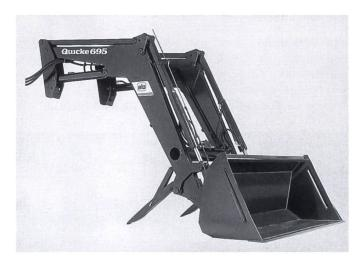
Die Firma Speriwa stellt Neuheiten aus dem erfolgreichen Frontladerund Arbeitsgeräte-Programm von Ålö Quicke vor. Die Neuerungen von Quicke 675 und 695: Die Hubkraft ist wesentlich grösser, die Schwinge erheblich kräftiger, die Parallelführung noch genauer. Die Hubhöhe von Quicke 695 bis zum Gelenkpunkt der Arbeitsgeräte beträgt 4,25 m. Quicke 465 ergänzt das Angebot an Frontladern ohne Parallelführung.
