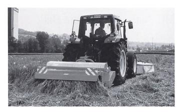
Auf Grund langjähriger Erfahrung entwickelte die Firma Otto Kurmann das neue Aufbereitersystem Twin, ein Intensivaufbereiter für die Silo- und Dürrfutterernte. Das System basiert auf einer dem Futterstrom entgegengestellten, angetriebenen Bürstenwalze mit ungleicher Umfangsgeschwindigkeit zum Zinkenrotor. Diese Technik bringt eine kürzere Trocknungszeit des Futters. Der minimale Bröckelverlust und der geringe
