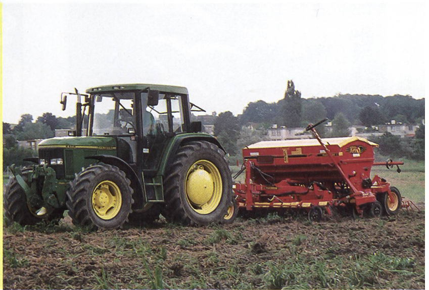
Leichtere Direktsämaschinen stellen einen gewissen Kompromiss zwischen schweren Direktsämaschinen und der konventionellen Sätechnik dar. Sie ermöglichen die Saat nach einer flachen Bodenbearbeitung mit Grubber, Scheiben- oder Spatenrolle oder nach einer herkömmlichen Bestellung.
