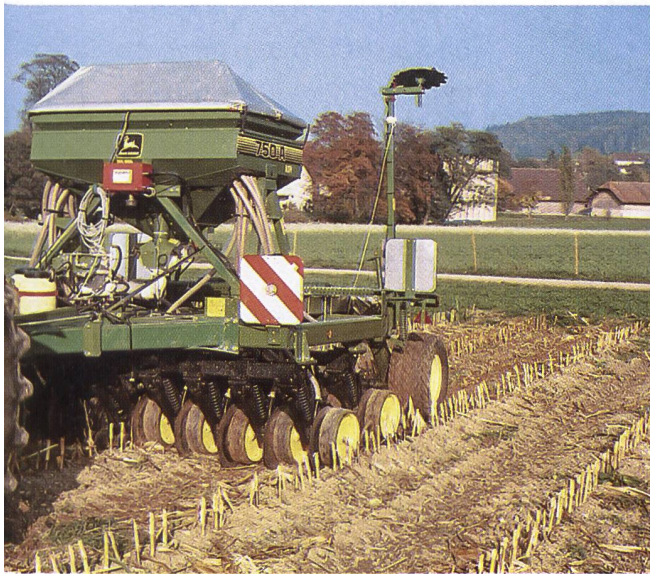
Schwere Direktsämaschinen besitzen den Vorteil, auch unter schwierigen Bedingungen den Samen präzise abzulegen.
