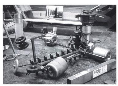
Obenentnahmefräse mit demontierbarem Kettenschutz. Nicht jeder Fräsentyp eignet sich zur Entnahme von Grassilage, welche mit dem Kurzschnittladewagen eingeführt wurde.
