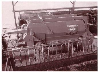
Selbstfahrender Vertikalmischer AVM mit Entnahmefräse (Werkbild).
