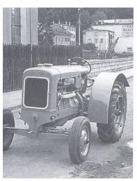
Vevey-Traktor Typ V2 aus dem Jahre 1937. Rarität: Eingebaut wurde ein Zwei-Takt-Gegenkolbenmotor. (Fotos: F. Morgenegg)
