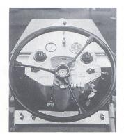
1962 gab es das schon: Die erste elektrohydraulische Schaltung auf dem zuletzt in Vevey gebauten Traktor «Rhone» (nur Prototyp). Man beachte den herausnehmbaren Drehschalter «vitesse avant» rechts auf der Konsole. Diese Schaltung war der direkte Vorläufer der «select-o-speed»-Schaltung gewesen, die Ford ein Jahr später in New York vorstellte.
