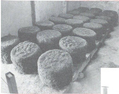
Abb. 4. Typ A: Die Ballen stehen frei auf einem Kanal mit Öffnungen von 100–120 cm.
