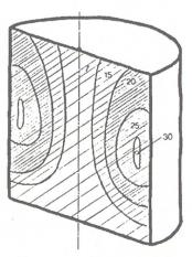
Abb. 2. Unterschiede in der Dichte ergeben Feuchtenester.
