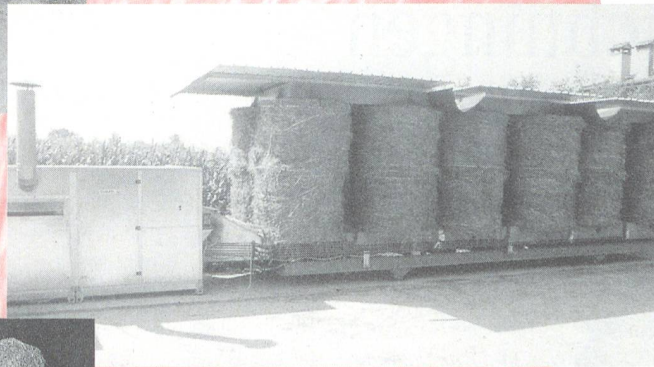
Abb. 5. Typ B: Je zwei Ballen werden zwischen Tellern mit 150 cm Durchmesser eingeklemmt.
