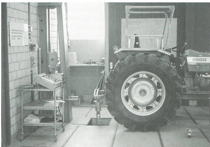
Abb. 10. Zunehmend schwerere Dreipunktanbaugeräte verlangen immer grössere Hubkräfte an der Dreipunkthydraulik. Der FAT-Bericht berücksichtigt die durchgehende Hubkraft, also jene, die über den ganzen Hubbereich erbracht wird. Zusatzhubzylinder können die Hubkraft um bis zu 50% vergrössern.
