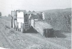
Hanf ist extrem ausfall- und wickelanfällig. Die Kornernte im Mähdruschverfahren muss daher möglichst frühzeitig erfolgen. Gewisse technische Anpassungen an der Maschine sind empfehlenswert.
