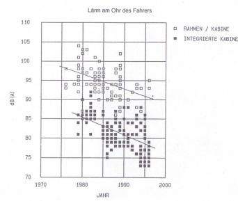
Die Lärmwerte, gemessen an Traktoren mit einfachen Fahrerkabinen oder Rahmen, liegen zum Teil noch immer über 90 Dezibel – ein Lärmwert, den es unbedingt zu vermeiden gilt. Erfreulich dagegen jene bei integrierten Kabinen, die 80 Dezibel zunehmend unterschreiten.
